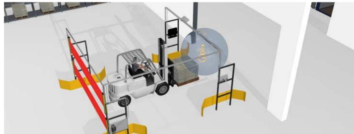
Turcks UHF-Schreib-Lese-Kopf Q300 erlaubt den Anschluss von externen passiven Antennen. Der vorprogrammierbare Multiplexbetrieb des Schreib-Lese-Kopfes spricht die Antennen abwechselnd an und sorgt so für eine schnelle Erkennung
