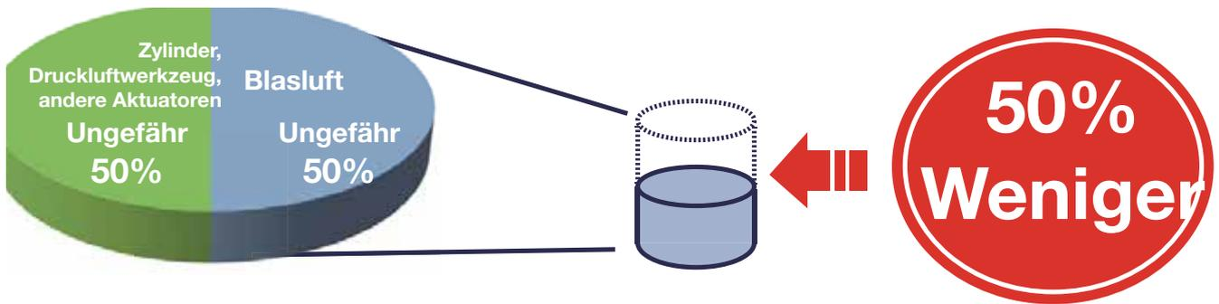
Mit einem Air Saver können wesentliche Vorteile erzielt werden. Der Blasluftanteil beträgt nahezu 50% der in Betrieben benutzte Druckluft. Mit seiner Schaltventil-Technik kann der Air Saver den Luftverbrauch um bis zu 50 % reduzieren!
