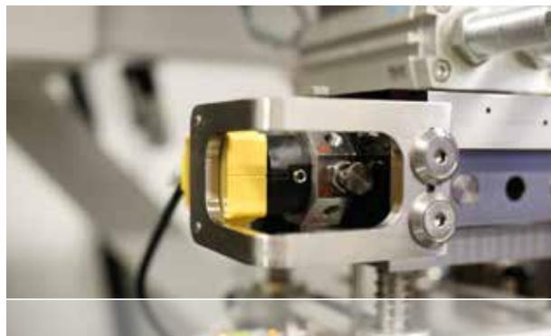
**Winkelsensor** zur Positionsermittlung einer Anschlag-Trommel auf 360°
