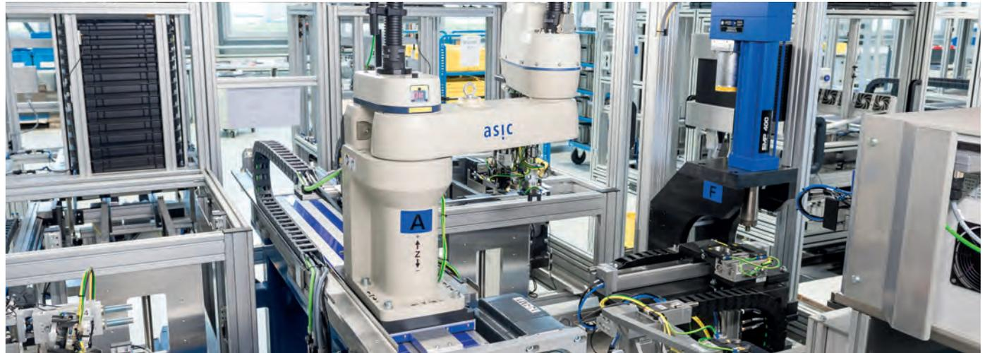
*L'axe linéaire Delta HSB avec entraînement par vis guide le robot flexible dans ses déplacements précis et infatigables.*
