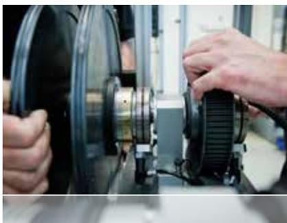
Embrayage à denture électromagnétique de Bachofen
