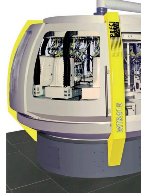
CNC-Rundtakt-Transfermaschine von Precitrame
