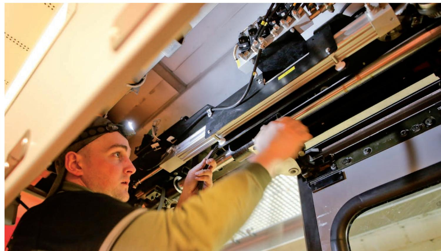
Obere Montage der gelieferten Bachofen-Antriebszylinder und Ventilblöcke für die Türöffnung/Türschliessung
