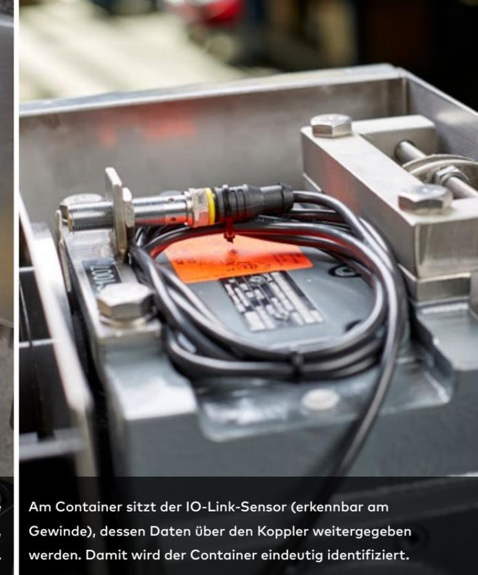
Am Container sitzt der IO-Link-Sensor (erkennbar am Gewinde), dessen Daten über den Koppler weitergegeben werden. Damit wird der Container eindeutig identifiziert.
