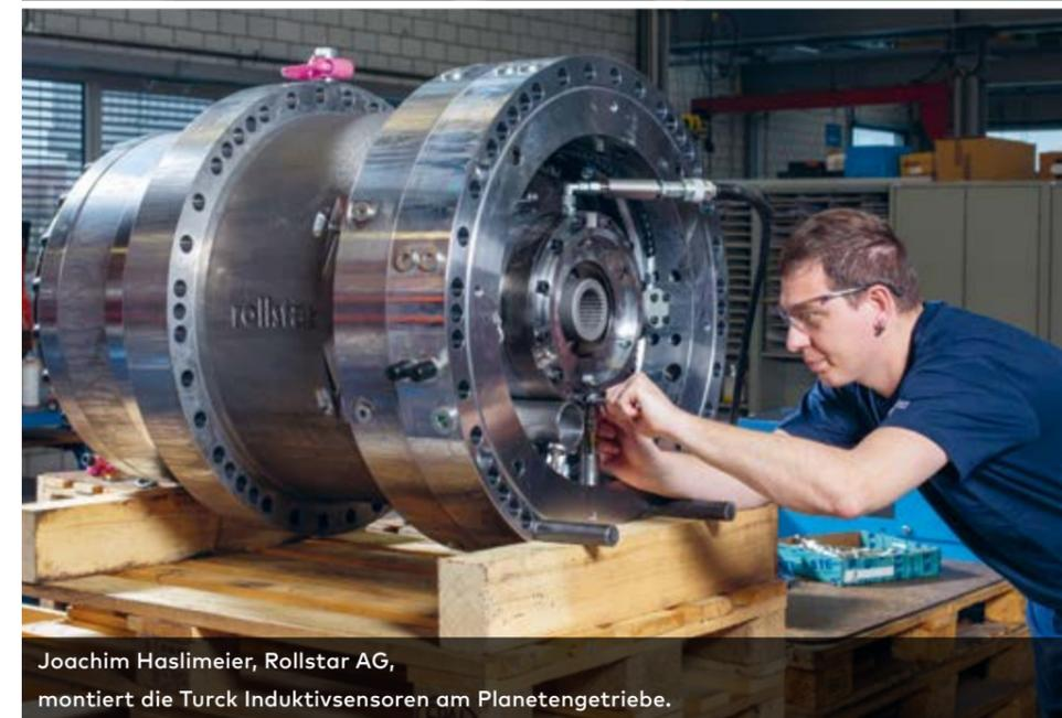
Joachim Haslimeier, Rollstar AG, montiert die Turck Induktivsensoren am Planetengetriebe.
