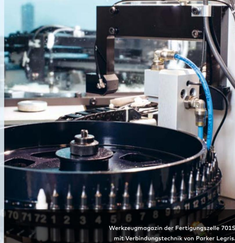
Werkzeugmagazin der Fertigungszelle 701S mit Verbindungstechnik von Parker Legris.
