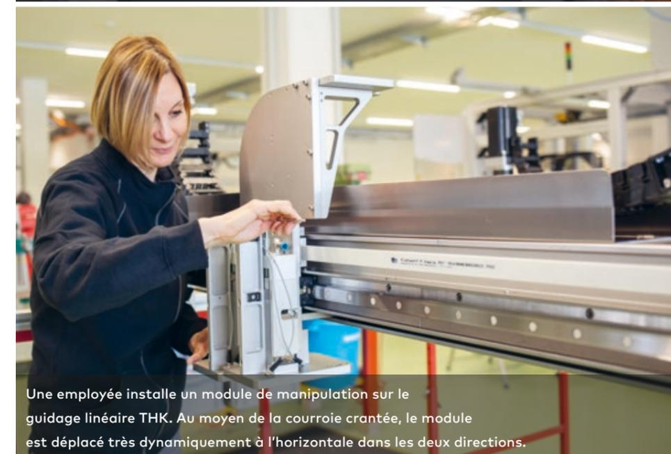
Une employée installe un module de manipulation sur le guidage linéaire THK. Au moyen de la courroie crantée, le module est déplacé très dynamiquement à l'horizontale dans les deux directions.
