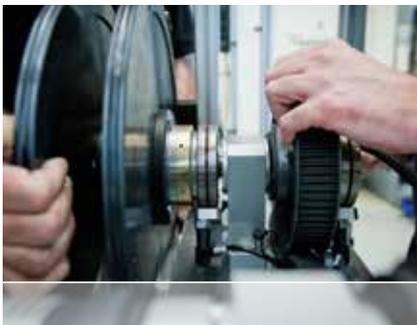
Embrayage à denture électromagnétique de Bachofen
