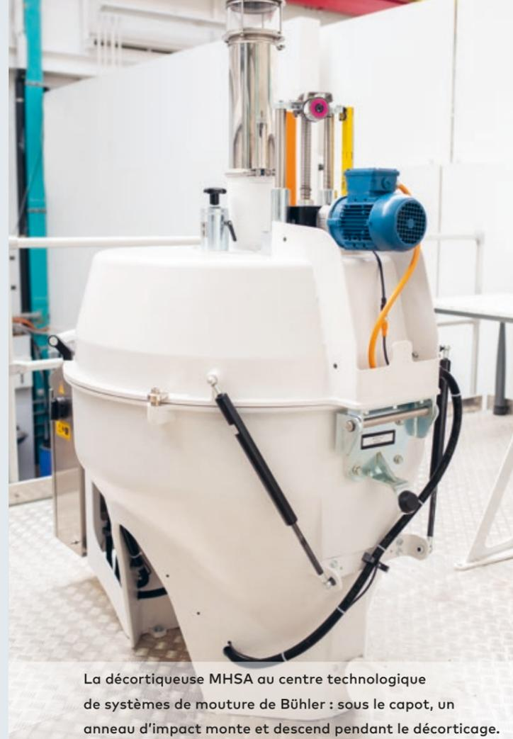
La décortiqueuse MHSa au centre technologique de systèmes de mouture de Bühler : sous le capot, un anneau d'impact monte et descend pendant le décortiquage.
