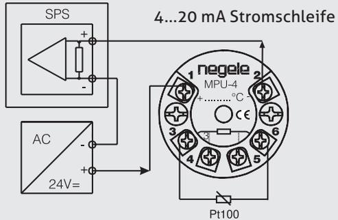
Elektrischer Anschluss mit zwei Kopftransmittern (TFP-62)
