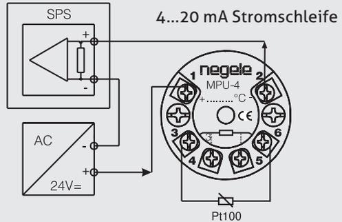
Elektrischer Anschluss mit zwei Kopftransmittern (TFP-62P)
