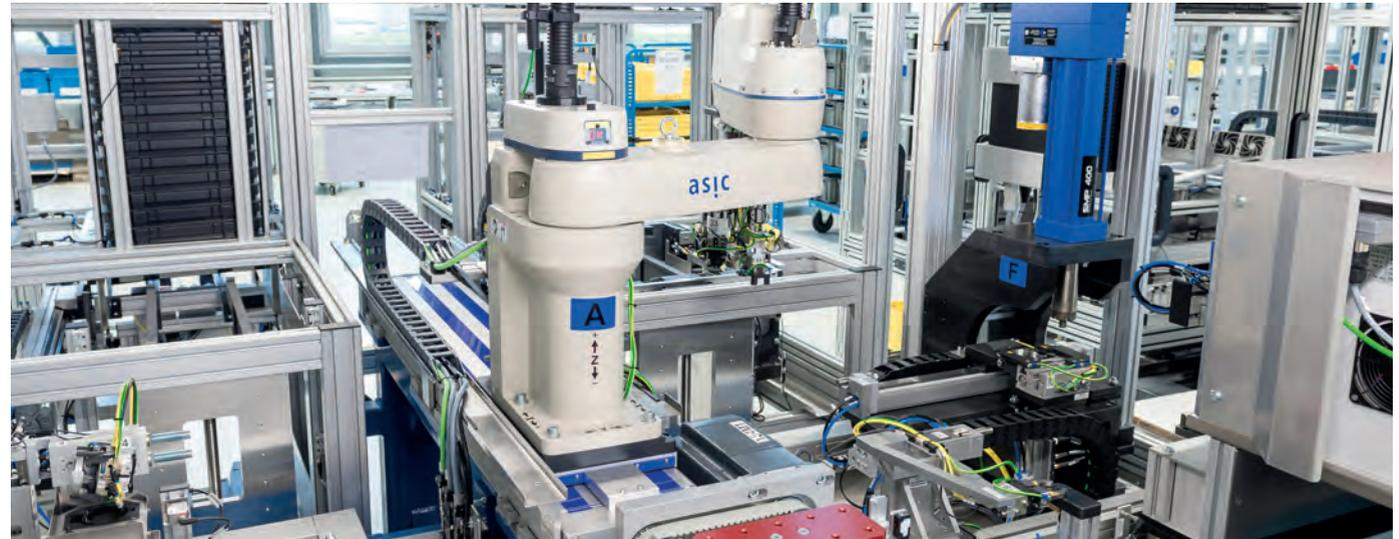
*Die HSB-delta® Linearachse mit Spindelantrieb führt den flexiblen Roboter auf seiner präzisen und unermüdlichen Reise.*
