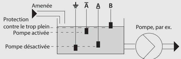
**Commande de niveau simple en cuve**
