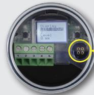
Anschlussstecker für MPI-200-F Adapter als Zwischenstecker zwischen ILM-4 Elektronik und MPI-200 Anschluss 3.
