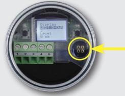
Anschlussstecker für MPI-200-F Adapter als Zwischenstecker zwischen ITM-51 Elektronik und MPI-200 Anschluss 3 (siehe nächstes Bild)
