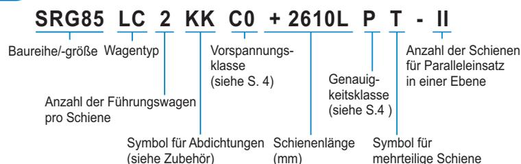
**Hinweis** Diese Bestellbezeichnung gibt ein Set mit einer Führungsschiene an. Für eine parallele Anordnung von zwei Schienen sind daher zwei Sets erforderlich. Diese mit dem Schmiersystem QZ ausgestatteten Typen können keinen Schmiernippel besitzen.
