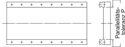
Parallelitätstoleranz (P) zwischen zwei Schienen
