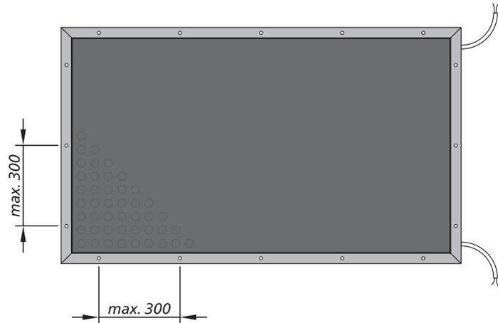
Der Signalgeber wird mit Schrauben min. Ø 5 mm (Empfehlung: Tellerkopfschrauben 6 x 50) auf dem Boden fixiert. Diese sind standardmäßig nicht im Lieferumfang enthalten. Der Abstand von Schraube zu Schraube darf maximal 300 mm betragen.
