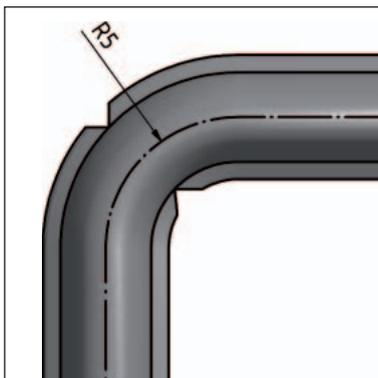
Auch kleine 90°-Biegungen lassen sich realisieren: Mit zwei gegenüberliegenden Schnitten in den überstehenden Teilen des Profilfußes sind für B<sub>3</sub> und B<sub>4</sub> kleinere Biegeradien bis 5 mm möglich.
