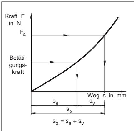
Grundlage für die Berechnung der Tiefe ist die Kraft  $F_G$ . Sie stellt eine Grenzkraft dar, bis zu der ein Signalgeber verformt, beziehungsweise weiter bewegt werden darf.
