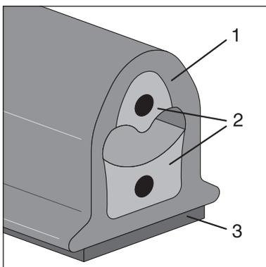
Die Miniaturschaltleiste EKS 038 besteht aus (1) isolierendem TPE-Mantel, (2) leitfähigen Kontaktschichten mit eingebetteten Litzen und (3) selbstklebendem Acrylic-Foam.
