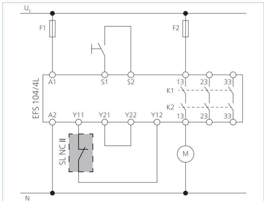
Die Öffner-Schaltleiste und das Schaltgerät SG-EFS 104/4L sind nach
