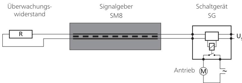
Der Überwachungswiderstand muss auf das Schaltgerät abgestimmt sein. Standard ist 8k2.
