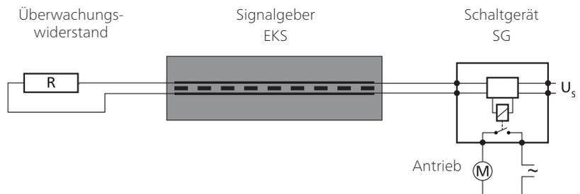
Der Überwachungswiderstand muss auf das Schaltgerät abgestimmt sein. Standard ist 8k $\Omega$ .
