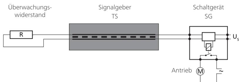
Der Überwachungswiderstand muss auf das Schaltgerät abgestimmt sein. Standard ist 1k $\Omega$ . Optional sind 8k $\Omega$  und 22k $\Omega$  möglich.
