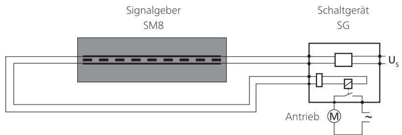
Die 4-Leiter-Technik kann nur mit dem Schaltgerät SG-EFS 104/4L eingesetzt werden.
