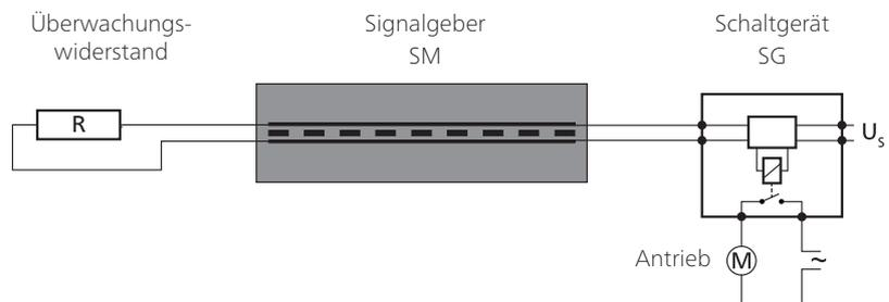
Der Überwachungswiderstand muss auf das Schaltgerät abgestimmt sein. Standard ist 1k $\Omega$ . Optional sind 8k $\Omega$  und 22k $\Omega$  möglich.
