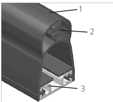
Die Schließer-Schaltleiste SP besteht aus einem Signalgeber (1 bis 3) (1) Kontaktprofil SP mit (2) integriertem Schließer-Schaltelement, (3) Alu-Profil C 15, C 25 oder C 30
