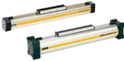
Il est, dans certains cas, adapté ou nécessaire d'avoir, à la place du couvercle standard orientable, les prises d'air dans l'axe du vérin. La position de la vis de réglage de l'amortissement peut être choisie comme il est nécessaire en orientant le couvercle de 4 x 90°.
