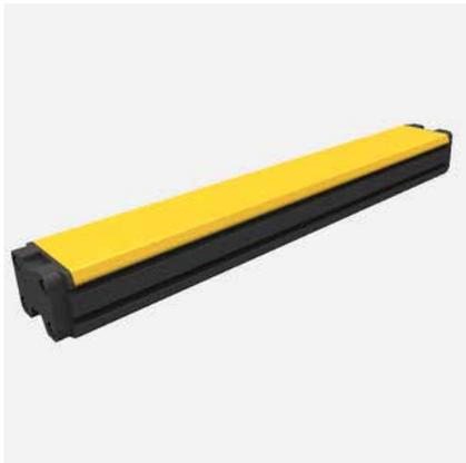
Die induktiven Linearwegensensoren arbeiten berührungslos und verschleißfrei nach einem revolutionären Messprinzip. Die Position wird nicht über einen magnetischen Positionsgeber erfasst, sondern über einen induktiven Schwingkreis. IO-Link dient neben der digitalen Übertragung von Prozesswerten auch zur anwendungsspezifischen Anpassung, beispielsweise durch Einstellung des Messbereichs.
