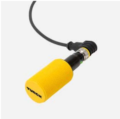
Die kapazitiven Sensoren der neuen BCT-Reihe mit IO-Link reduzieren den Aufwand für die Schaltungseinstellung und erweitern durch einen digitalisierten 12-Bit-Prozesswert die Nutzbarkeit der Messsignale. Darüber hinaus lassen sich durch die optimierte Kompensation der Oberflächenbenetzung Anhaftungen an der Sensoroberfläche ausblenden und so ein Schaltungspunkt drift verhindern.
