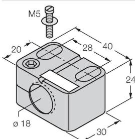
Befestigungsschelle für Gewinderohrsensoren, mit Festanschlag; Werkstoff: PA6
