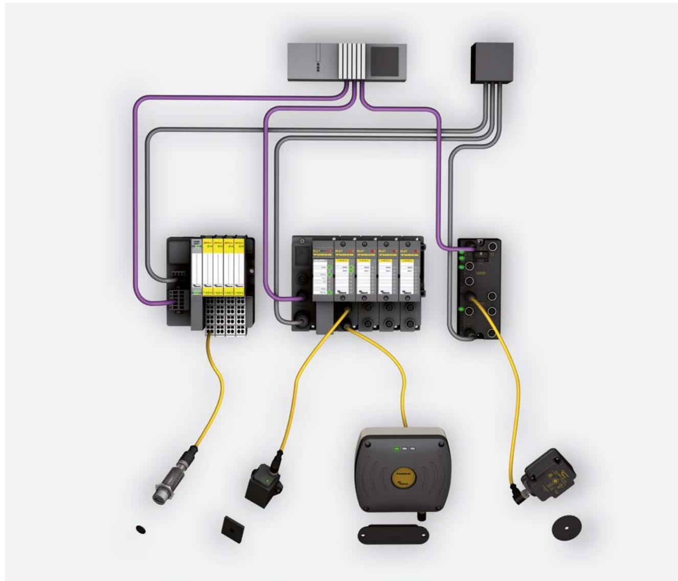
BL ident® ist ein modulares RFID-Komplett-system, das seine Stärken auch in der Lebensmittelindustrie ausspielt. Basis sind die TURCK-I/O-Systeme BL67 (Feldmontage) und BL20 (Schaltschrankmontage) bzw. die kompakten Feldbusmodule BL compact (Feldmontage). Mit BL ident® können Sie HF-Technik (13,56 MHz, gemäß ISO 15693) und UHF-Technik (865...928 MHz, gemäß ISO 18000-6C/EPCglobal Class 1 Gen 2) parallel nutzen.
