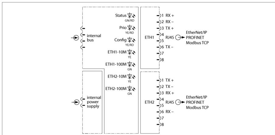
La passerelle sert à la connexion du système excom à un bus de terrain Ethernet supérieur avec prise en charge des protocoles Modbus TCP, Ethernet/IP et PROFINET. Le raccordement au bus de terrain se fait par un connecteur RJ45 standard avec une qualité de câble minimalement CAT5e. Grâce au switch intégré, une topologie annulaire suivant DLR ou MRP peut être implémentée.
