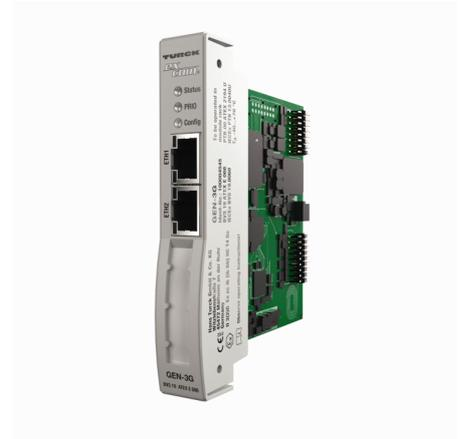
Das Gateway dient zur Anbindung des excom-Systems an einen übergeordneten Ethernet-Feldbus mit Unterstützung der Protokolle Modbus TCP, Ethernet/IP und PROFINET. Der Anschluss an den Feldbus erfolgt über Standard RJ45 Stecker mit mindestens CAT5e Leitungsqualität. Durch den eingebauten Switch kann eine Ring-Topologie gemäß DLR oder MRP implementiert werden.
